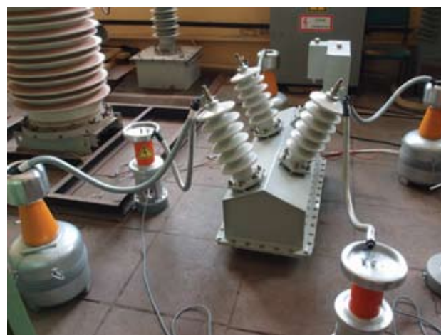
Поверка трехфазного НАМИ-35 с применением УПТВ-3-35
