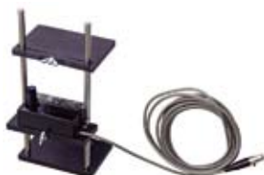
УФС-И, УФС-Э (устройства фотосчитывающие с диска и светодиода)
