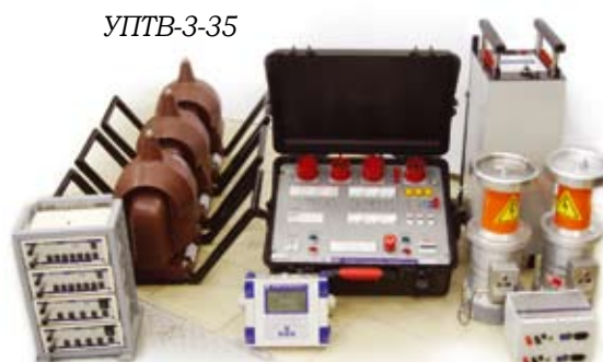
Поверка трехфазного НАМИ-35 с применением УПТВ-3-35
