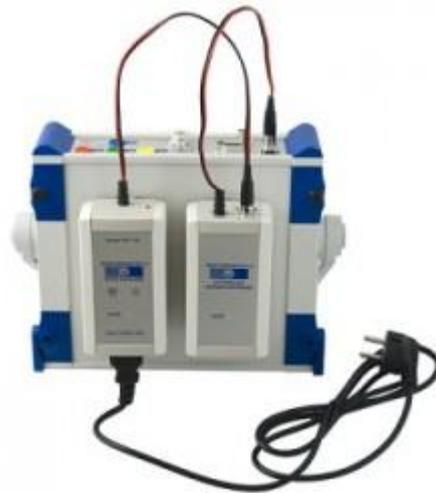
Предназначено для временного электропитания прибора «Энергомонитор-3.3Т1». В состав УЗП входит аккумуляторная батарея с постоянным напряжением 12 В (10x1,2 В). Заряд осуществляется от сети переменного тока 85÷264 В, (50 ± 5) Гц через адаптер питания 220/16 В из комплекта прибора.
