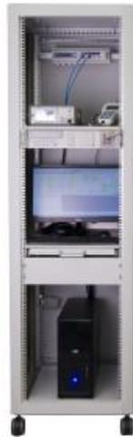
Установки предназначены для калибровки и поверки измерительных преобразователей (ИП) или электронных трансформаторов напряжения или тока, выходные сигналы которых представлены цифровым потоком в формате стандарта IEC 61850-9-2LE, или в формате стандарта IEEE-488.2, путем сравнения (компарирования) их с аналоговыми выходными сигналами эталонных ИП напряжения (номинальные значения: 0,07; 0,7; 7; 70 и 240 В) или эталонных ИП тока (номинальные значения в диапазоне от 0,1 до 10 А).
