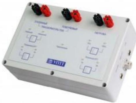
Устройство проверки трансформаторов тока (УПТТ), предназначено для проверки измерительных трансформаторов тока (ИТТ). УПТТ представляет собой масштабный преобразователь тока с устройствами коммутации. Прибор Энергомонитор-3.3Т1 в комплекте с УПТТ-3.3 позволяет осуществлять проверку ИТТ со значением тока вторичной обмотки 1 или 5 А класса точности до 0,2S.
