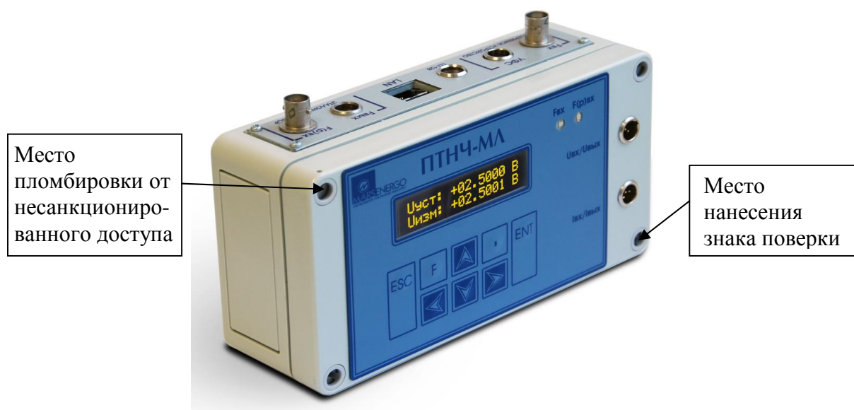
Рисунок 2 - Общий вид Приборов модификаций ПТНЧ-МЛ, место пломбировки от несанкционированного доступа и обозначение места нанесения знака поверки
