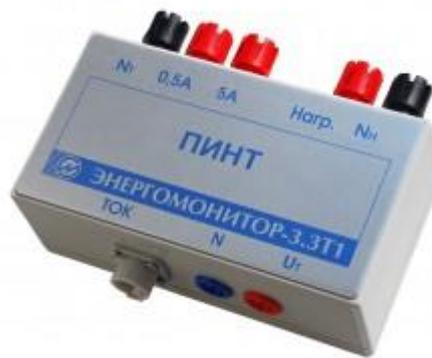
Если в комплект поставки Прибора Энергомонитор-3.3Т1 не входят токоизмерительные клещи 10А или БТТ 5А, мощность нагрузки измерительного трансформатора может быть измерена с помощью ПИНТ (с подключением в разрыв вторичной цепи). Погрешность измерения полной мощности  $\pm 0,2\%$ .
