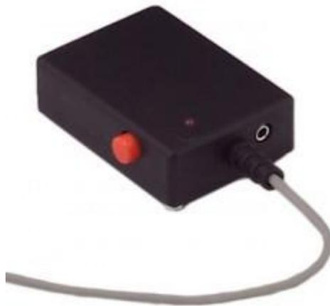
ПФИ предназначен для формирования импульсов и передачи их на вход «Fвх» Прибора ЭМ-3.3Т1. ПФИ может применяться совместно с Прибором ЭМ-3.3Т1 для контроля метрологических характеристик индукционных и электронных однофазных и трехфазных счетчиков активной и реактивной электрической энергии на месте эксплуатации, а также для поверки электронных счетчиков с телеметрическим импульсным выходом.
