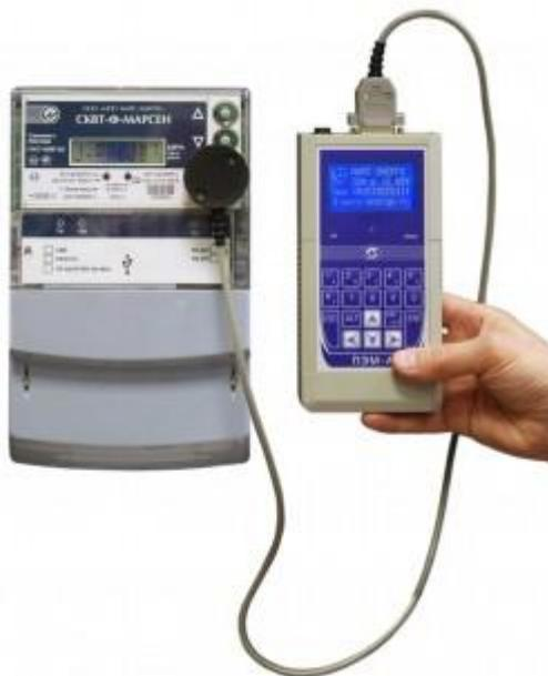
Прибор энергетика ПЭМ-А используется инспекторами сбытовых компаний и энергетиками промышленных предприятий для считывания информации (снятия показаний) со счетчиков электроэнергии на месте их эксплуатации.
