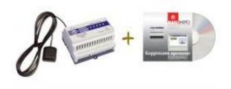
Предназначен для обеспечения единого времени путем автоматической подстройки внутренних часов приборов, входящих в систему, под Всемирное Координированное Время (UTC). В комплекте имеется внешняя антенна с магнитным основанием. Внешние приборы могут подключаться к модулю по интерфейсу RS-485 и должны поддерживать протокол обмена Modbus RTU. Также модуль выдает дискретный сигнал частотой 1Гц, синхронизированный с UTC.
