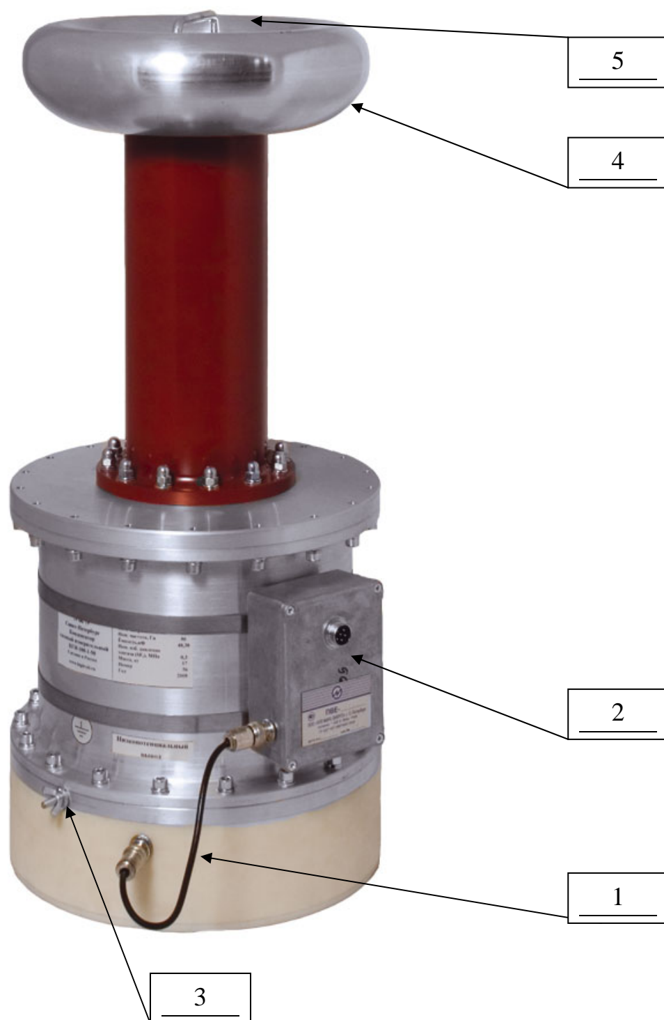
Рисунок 2.5.в. Общий вид ПП для ПВЕ-110. 1 - кабель К1 для подключения ПТН к выходу КГИ; 2 – соединитель для подключения к УИН; 3 – клемма заземления; 4 – клемма высоковольтного электрода; 5 – ручка для переноски.
