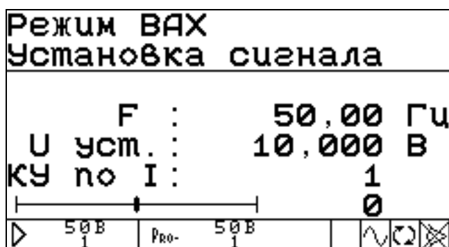
Рисунок 4.4 Окно задания параметров сигнала для режима ВАХ
