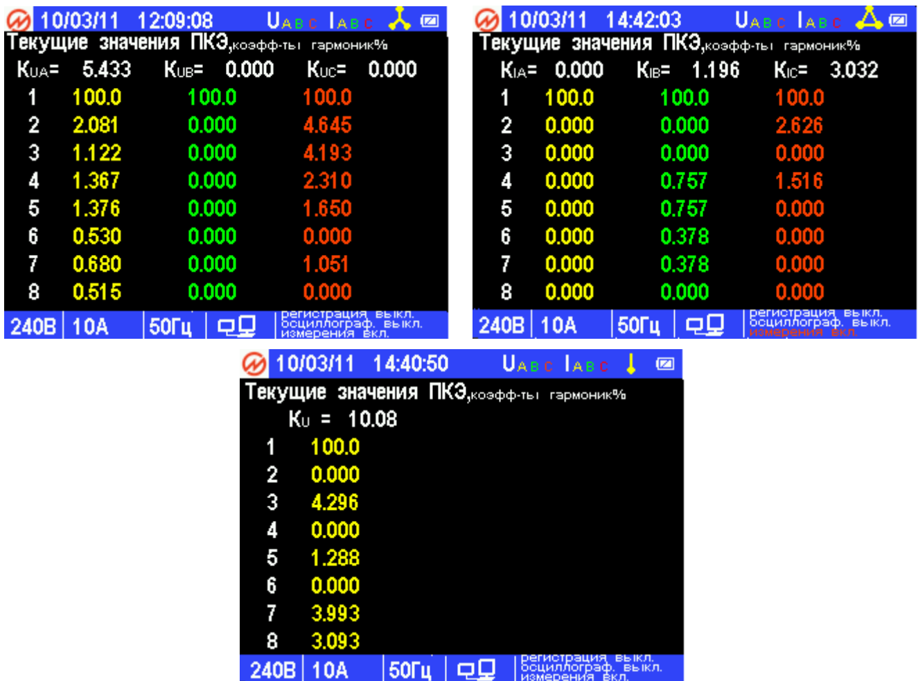
Рисунок 4.30. Окно отображения текущих значений коэффициентов искажения синусоидальности и гармонических составляющих напряжений и токов для различных схем подключения
