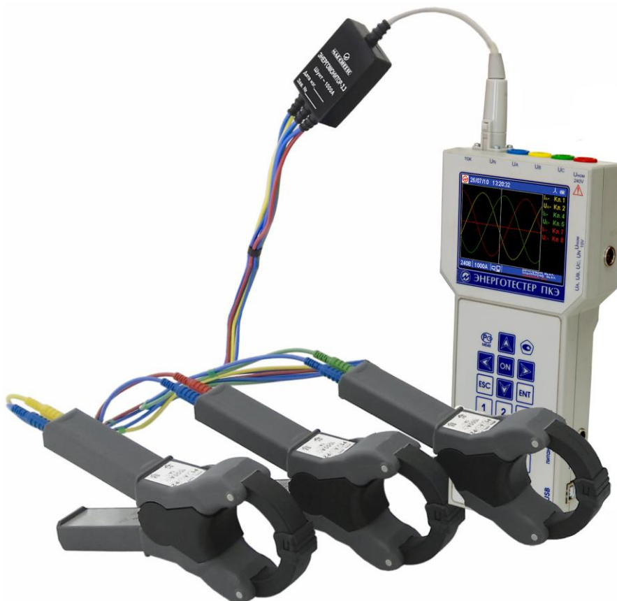
Рисунок А8 Схемы подключения токоизмерительных клещей 1000А к Энерготестеру ПКЭ-А через Шунт 100А.
