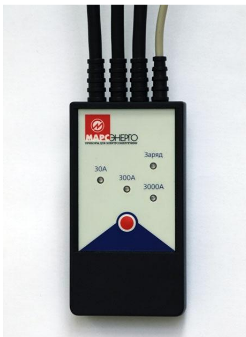
Рис. А.12. Трехдиапазонный усилитель токоизмерительных клещей на 30/300/3000 А с блоком выбора рабочего предела
