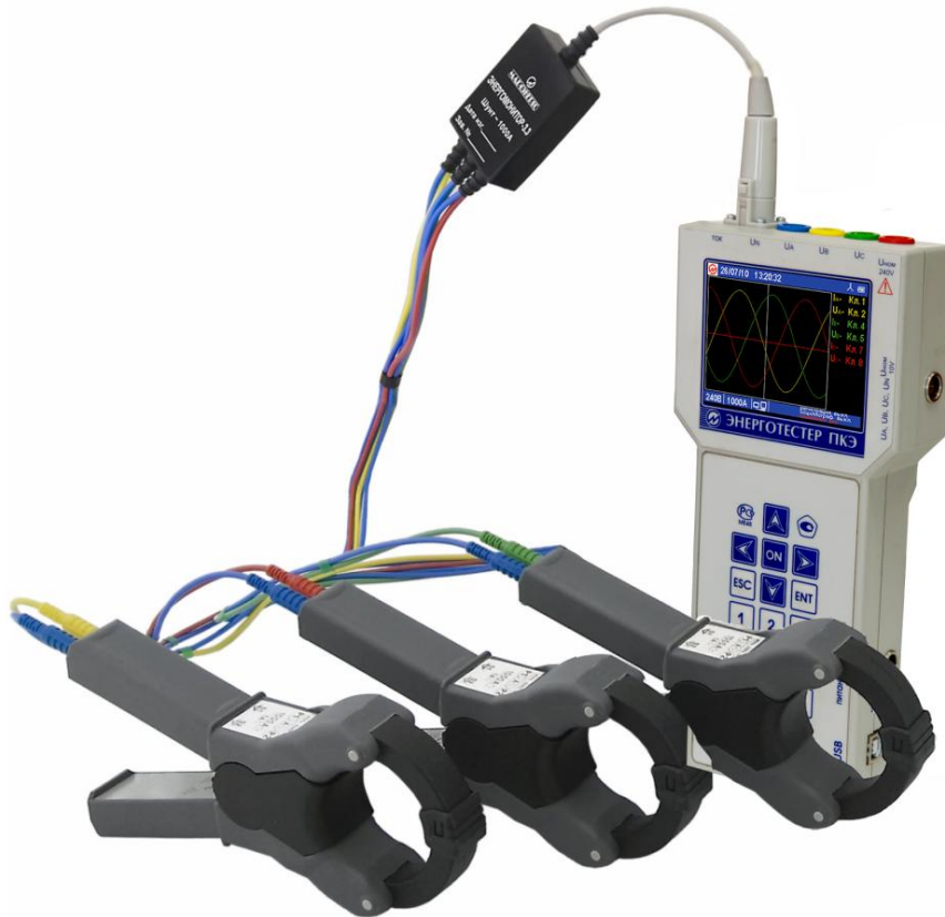
Рисунок А7 Схемы подключения токоизмерительных клещей 1000А к Энерготестеру ПКЭ-А через Шунт 1000А.
