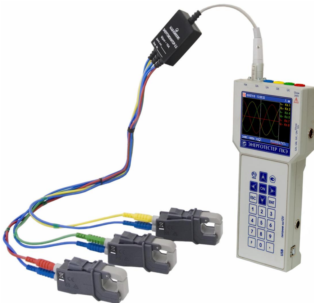
Рисунок А3 Схемы подключения токоизмерительных клещей 10А к Энерготестеру ПКЭ-А через Шунт 10А.
