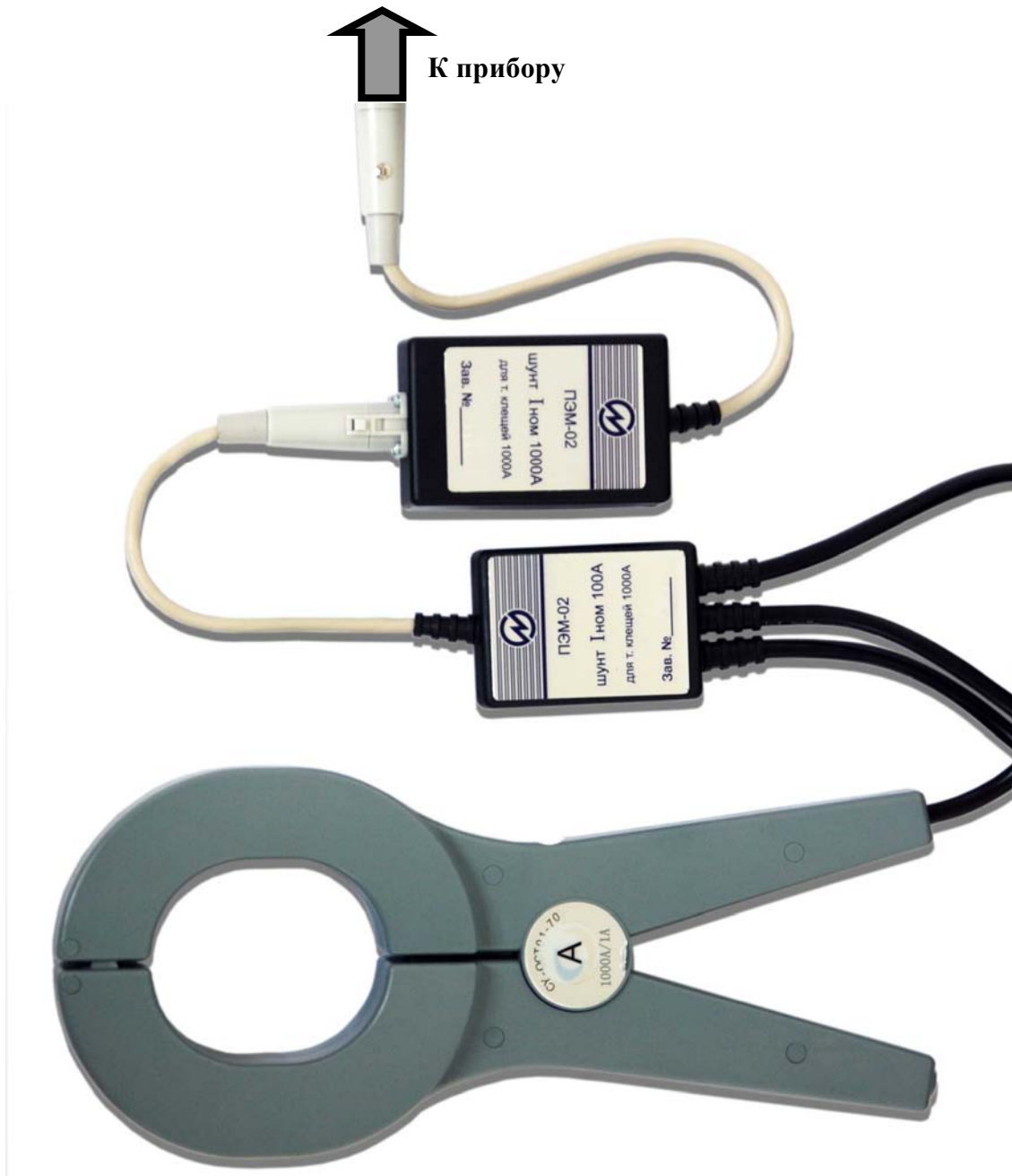
Рис. А.7. Схема подключения токоизмерительных клещей 1000 А к Прибору ПЭМ-02 через шунты I_n = 100 А и I_n = 1000 А для измерений на пределе 1000 А
