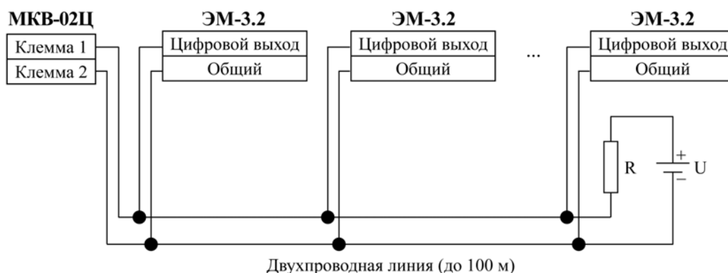
Рис. А.1. Схема подключения Модуля МКВ-02Ц к Приборам «Энергомонитор-3.2»
