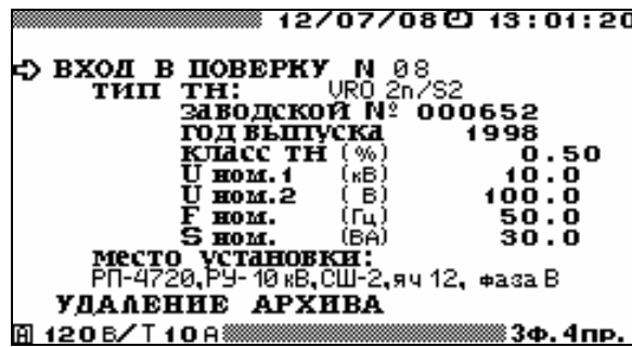
Рисунок 4.6.2 Окно параметров поверки трансформаторов напряжения
